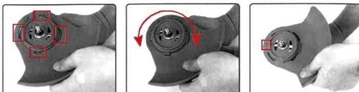
1. Вставьте защитную пластину в угол паза.
